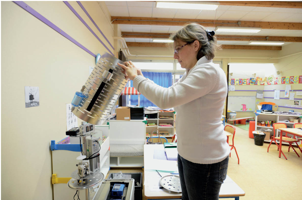
Mesure des COV, NO 2 , COSV, particules, CO 2 , température, humidité et bruit.
